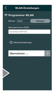
Die Konfiguration der Einkabel-Steckdosen der TECHNIPRO RV 700 E Serie erfolgt mit der App RVcontrol sowie dem PROGRAMMIERADAPTER RVP 700.
